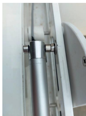
La douille doit toujours pouvoir tourner librement sur elle-même
