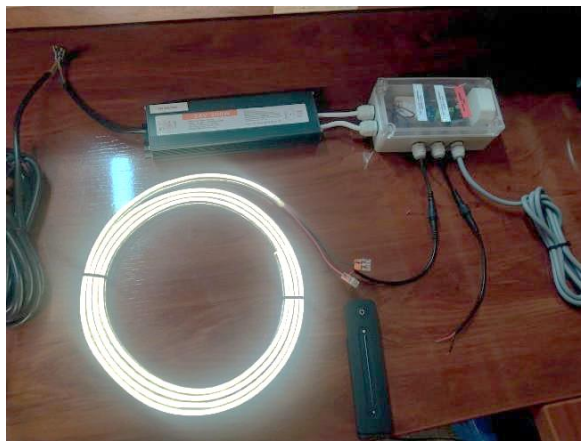
Test fonctionnement éclairage LED
